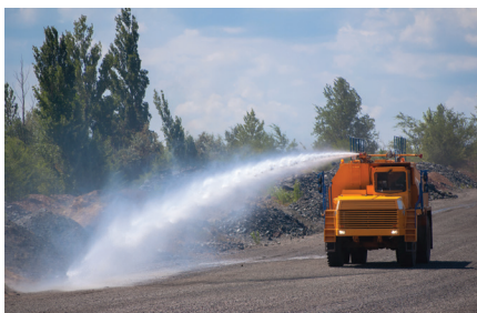
AS ESTRADAS NÃO PAVIMENTADAS SERÃO TRATADAS COM ÁGUA DURANTE O TEMPO SECO PARA SUPRIMIR AS POEIRAS
